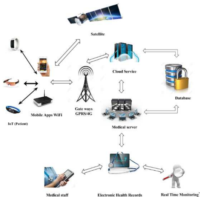
Figure 1: La topologie de l'IoT du réseau de santé:
